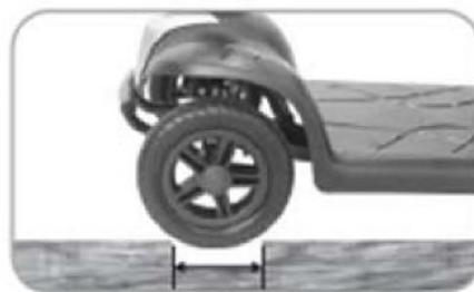
Al conducir el scooter por una rampa, ajustar el centro de gravedad del cuerpo para mayor seguridad.
